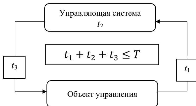
Рис. 1. Классический контур системы управления организацией, где t_1 – время на передачу информации об объекте управления, t_2 – время на выработку решения, t_3 – время на управляющее воздействие, T – плановое или нормативное время решения
